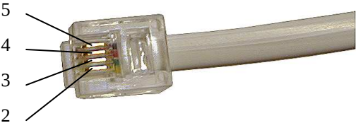
Нумерация контактов вилки 6P4C (контакты 1 и 6 отсутствуют)
