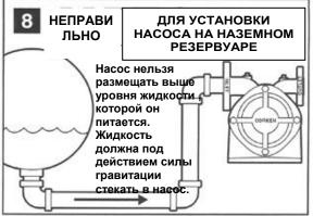
Сжиженный газ кипит вследствии падения давления всасывания у входа насоса. Поэтому, необходим гравитационный подвод для обеспечения непрерывной работы насоса.
