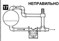
В испарительно-питательных насосах, обратный клапан должен быть установлен между насосом во избежание обратного оттока пара из входящего насоса
