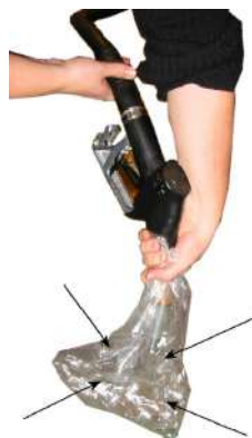
внутри пластикового пакета создается ваку- ум
