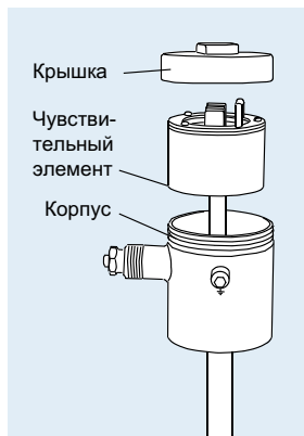
Рис. 3. Демонтаж чувствительного элемента
