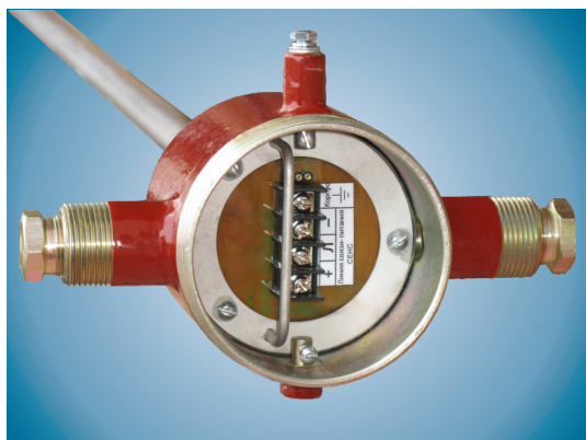
Рис. 2. Вид со стороны клеммных зажимов (крышка ПМП снята).
