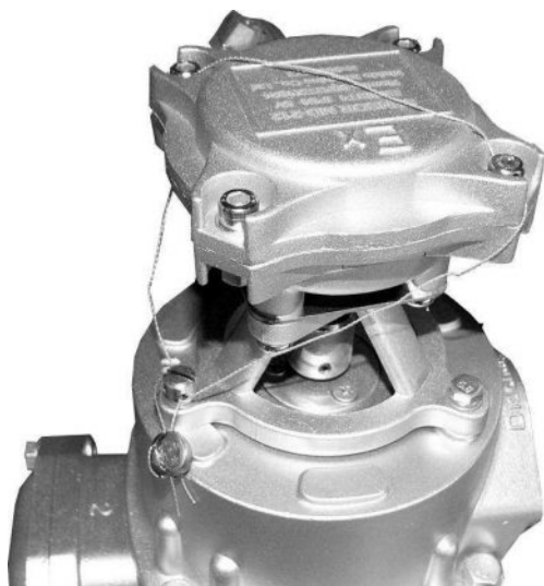
Рисунок В.1 Пломбировка генератора импульсов
