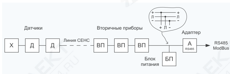
Рис. 1. Пример соединения системы измерительной “СЕНС” для вывода данных на систему верхнего уровня систем телеметрии (RS-485 ModBus)
