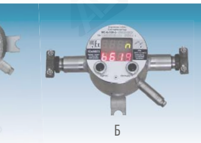
Рис. 14. Сигнализатор MC-K-500(-2)-НЖ (рис. А) имеет корпус, выполненный из стали 12Х18Н10Т, полость корпуса заполнена компаундом, MC-K-500-2-НЖ2 (рис. Б) имеет корпус, выполненный из стали 12Х18Н10Т, вид взрывозащиты "d" улучшает удобство подключения и ремонтпригодность
