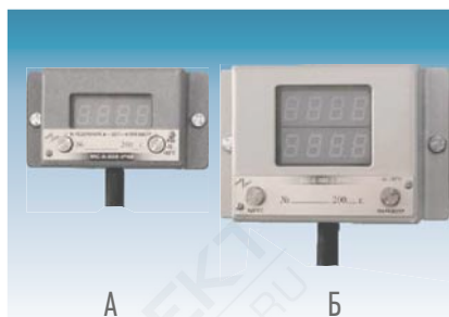
Рис. 13. Сигнализаторы ВС-K-500 (А) и ВС-K-500-2 (Б) поставляются с кабелем длиной 1,5 м (или другой длиной под заказ). Возможно исполнение с кабелем, выходящим из задней панели корпуса, предназначенным для монтажа сигнализатора на щите (В). Панель сигнализатора ВС-K-500 (В) может иметь надпись измеряемого параметра ("Уровень", "Температура"... – по заказу) для размещения на щите нескольких сигнализаторов с индивидуальной индикацией одного измеряемого параметра.
