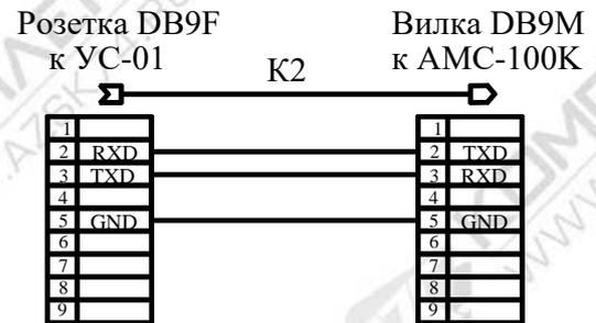
Схема электрическая подключения контроллера "Агат-12мк4" к ККМ "Samsung ER 4615K" ("Samsung ER 250K")
