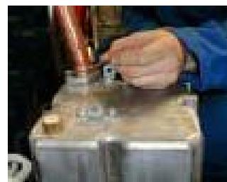
9) Если установлен насос вентилятора на стороне В колонки, то при помощи гаечного ключа 22 мм отсоедините колено насоса и капельницу.
