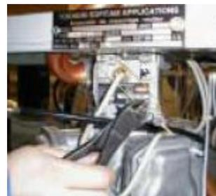
3) С помощью крестообразной отвертки TX20 отсоедините четыре звездообразных шурупа на корпусе пульсатора. Достаньте пульсатор из корпуса.
