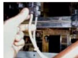
5) Отсоедините кабель пульсатора от панели WWC.
