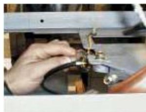
14) С помощью гаечного ключа 10 мм подсоедините фланец на 2 болта, чтобы соединить насос к счетчику.
