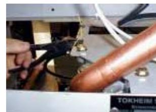
5) С помощью гаечного ключа 10 мм отвинтите и снимите 2 болта на фланце в верхней части счетчика, чтобы отсоединить счетчик от шланга. Слейте остатки топлива в подходящий контейнер.
