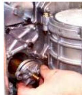
5) Вставьте новый шток перепускного клапана в корпус.
