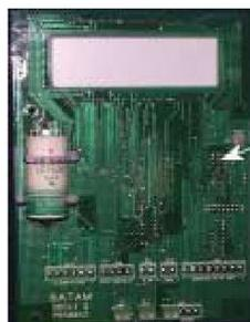
Для включения питания перемычка должна быть соединена с терминалом на плате Cecli2.
